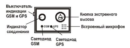
**Зеленый светодиодный индикатор синала GSM** - индицирует нахождение автомобиля в зоне работы сети GSM.
