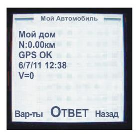
**Внимание.** При установке зоны контроля убедитесь, что во втором сообщении с местоположением автомобиля, даннные о качестве сигнала GPS соответствуют его готовности (GPS OK) и название указанного объекта соответствует реальному положению автомобиля.
